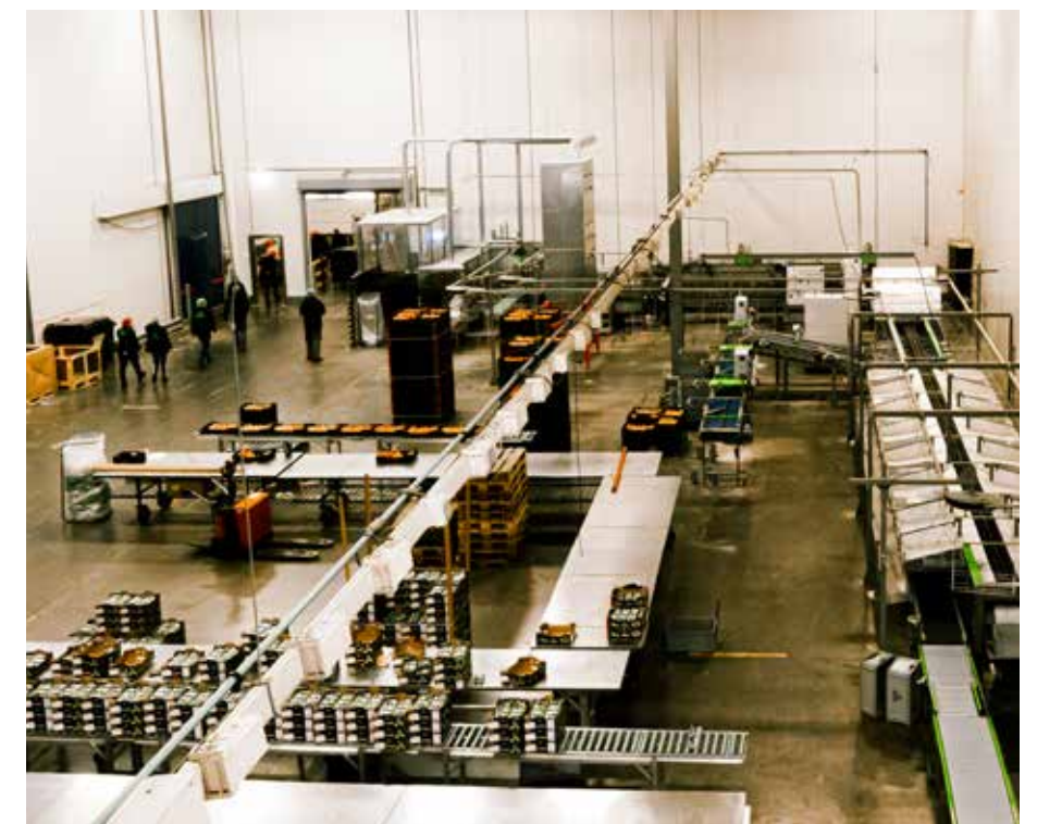
Bovenaanzicht citruswaslijn, het begin van de lijn is ingepakt met stoftenten
